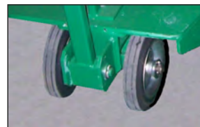
Lenkeinheit statt Deichsel Steering unit instead of drawbar Mécanisme de direction au lieu de timon
